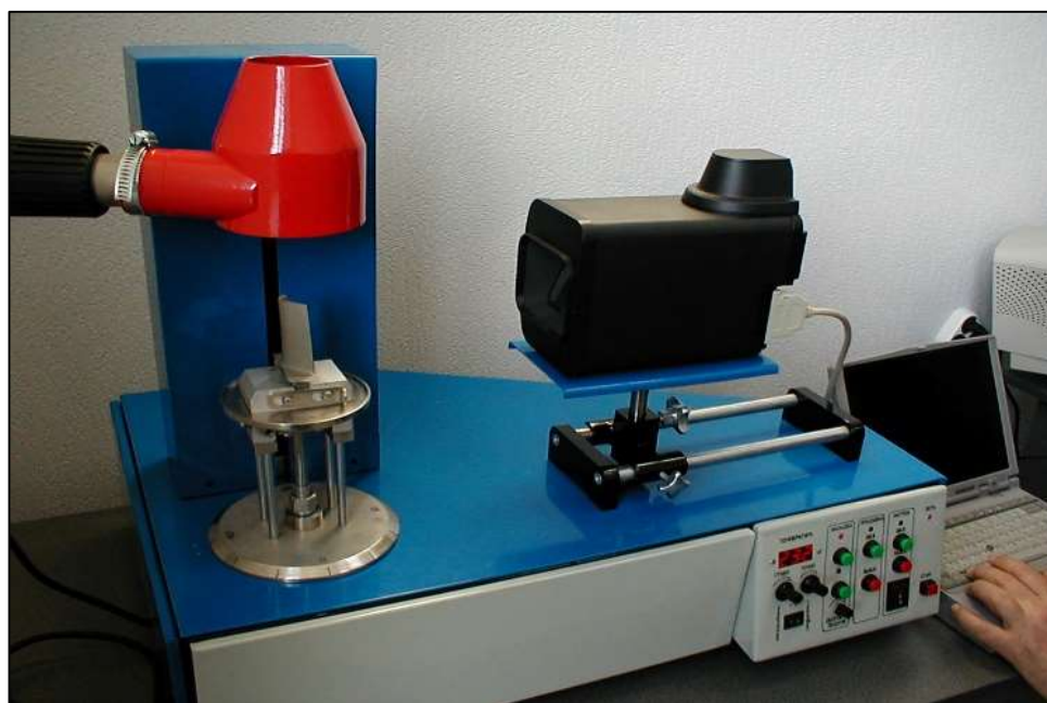
Установка СТКЛ-1 для тепловой дефектоскопии лопаток авиационных двигателей.
