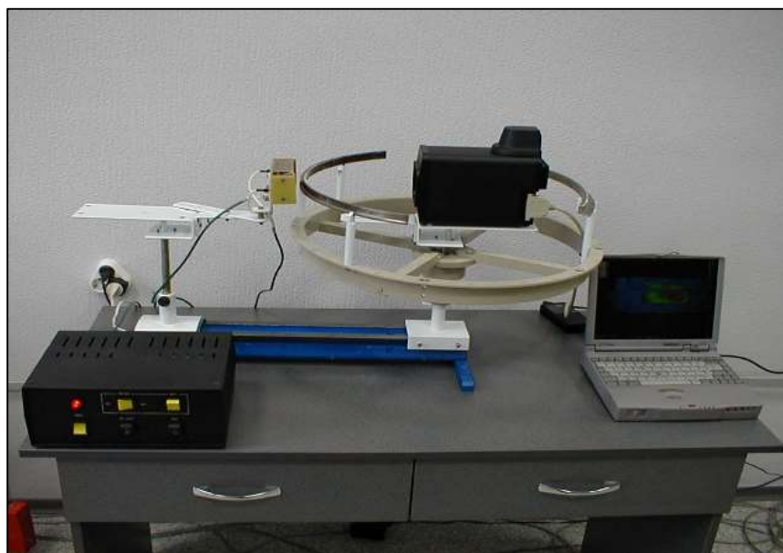
Стенд для тепловой дефектоскопии элементов авиационных двигателей с жаропрочными покрытиями
