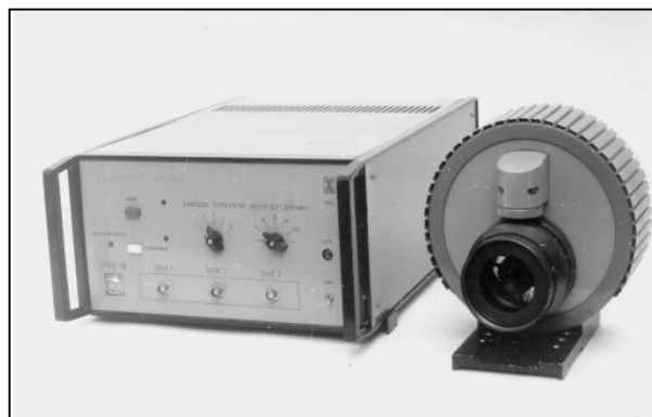
Радиометр ИИ – 40А для контроля жаропрочных керамических покрытий.
