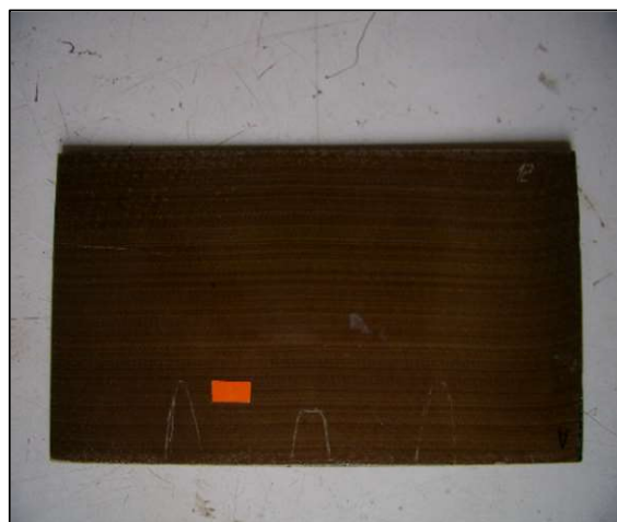
Стеклопластик, обнаружены три дефекта на разной глубине
