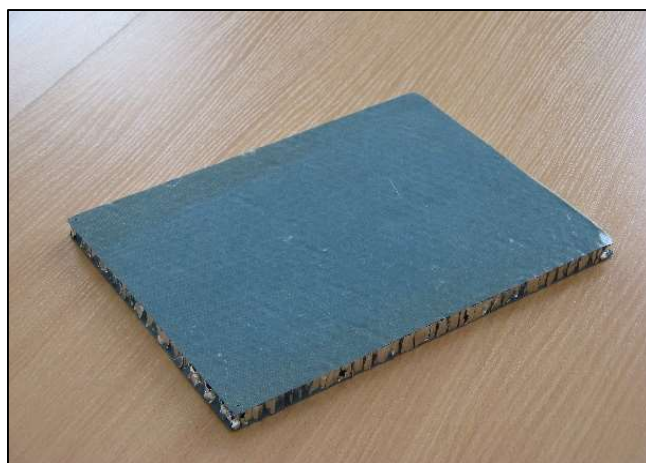
Композит «стеклопластик–алюминиевые соты–стеклопластик».
