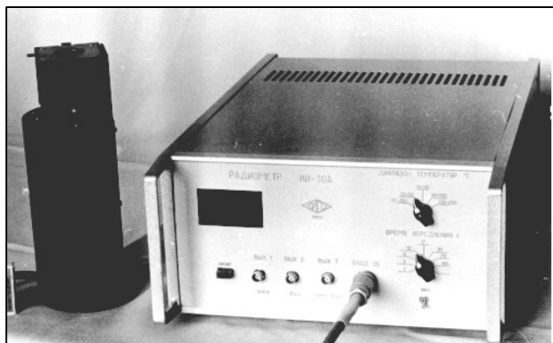
Радиометр ИИ – 30А для теплового контроля теплообменных аппаратов
